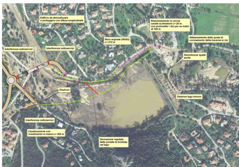
Figura 17. Interventi di messa in sicurezza del tratto d'asta presso il lago di Poggio dei Pini: planimetria di inquadramento
