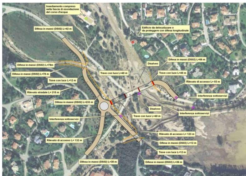
Figura 16. Interventi di messa in sicurezza del tratto d'asta a monte del lago di Poggio dei Pini: planimetria di inquadramento
