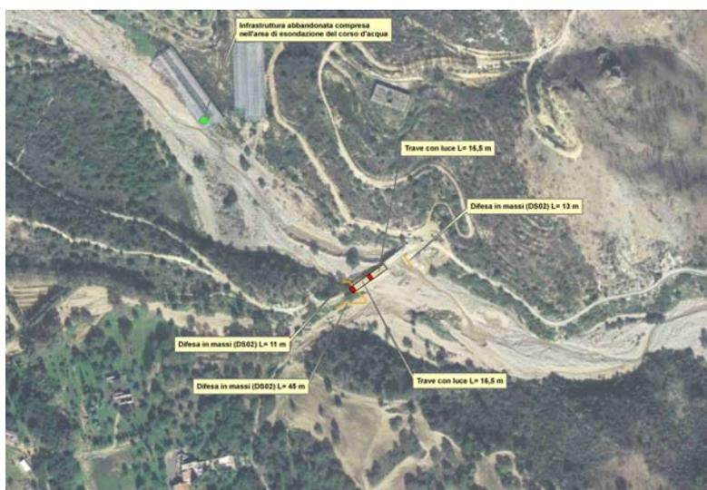
Figura 14. Interventi di messa in sicurezza dell'attraversamento comunale per loc. San Girolamo: planimetria di inquadramento
