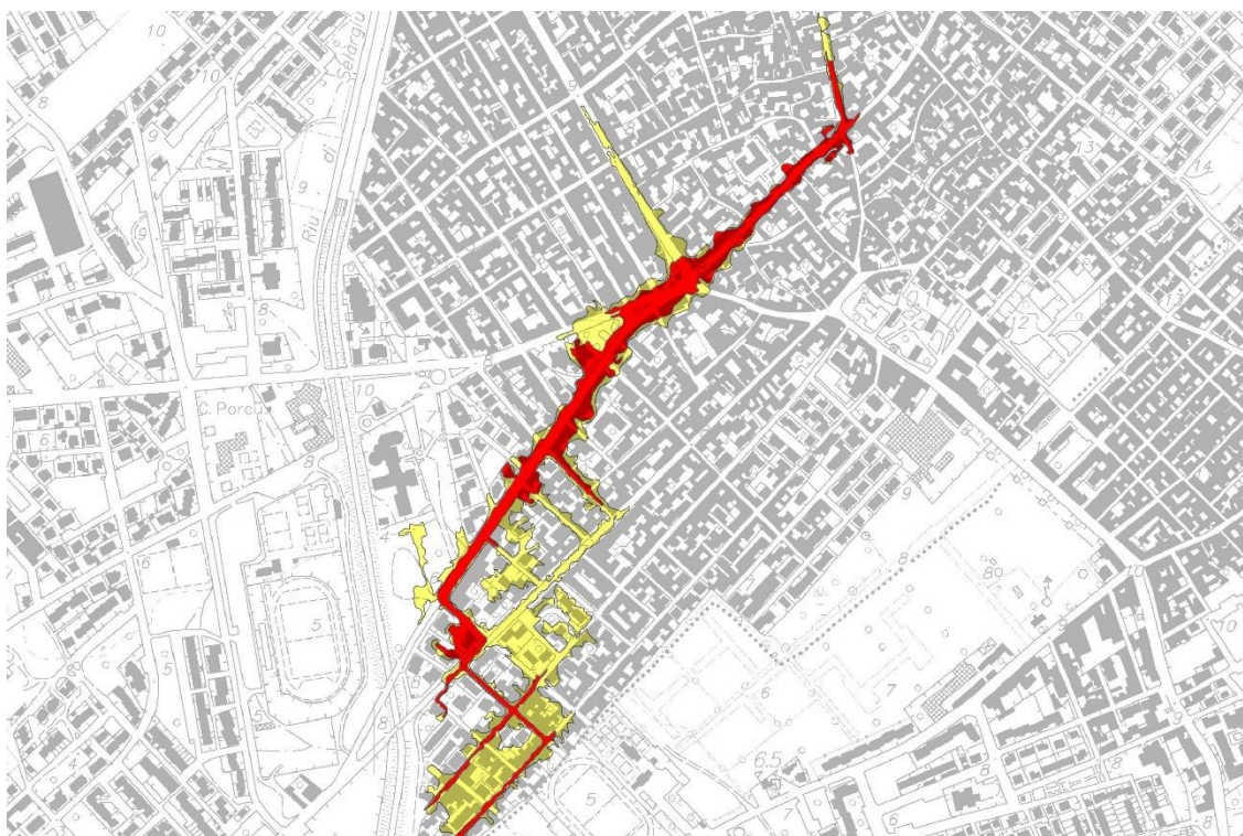
immagine 15. L'immagine mostra la copertura risultante dalle fasi di elaborazione delle aree pericolose (Hi4) e delle aree critiche (Hi*).
