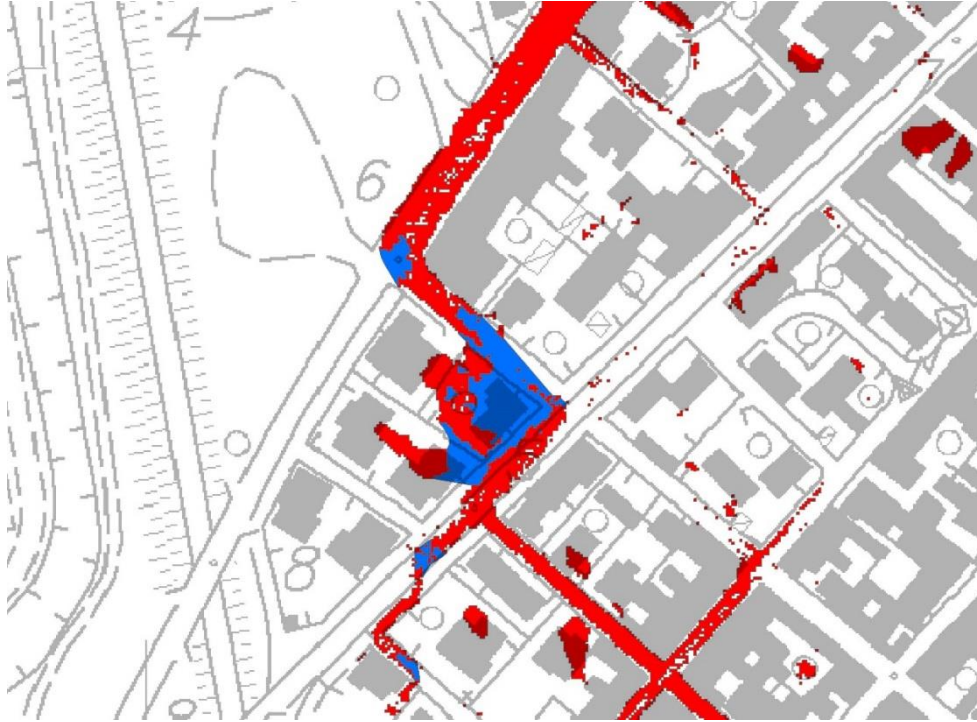
immagine 4. L'immagine mostra il ripristino della continuità del fenomeno di scorrimento tra le aree adiacenti effettuato manualmente. Le aree ripristinate sono evidenziate in azzurro.
