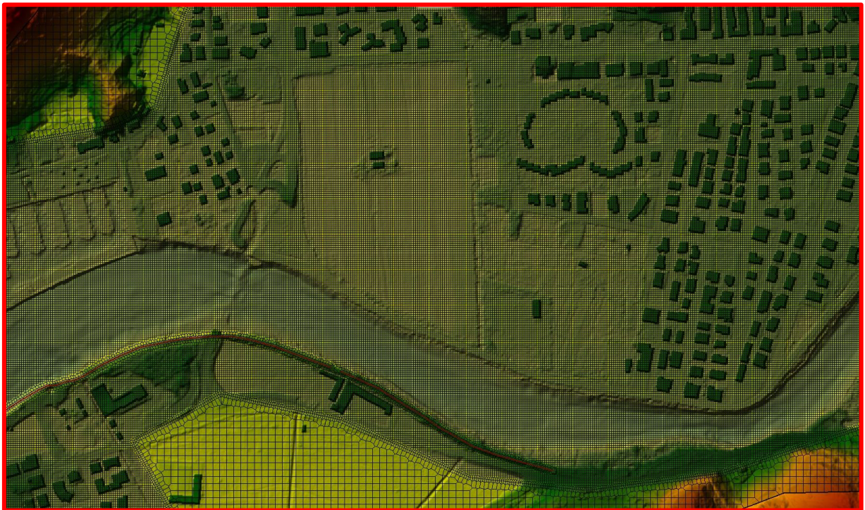
Figura 12 – Modello idraulico del fiume Temo – Esempio di differente risoluzione della mesh di calcolo
