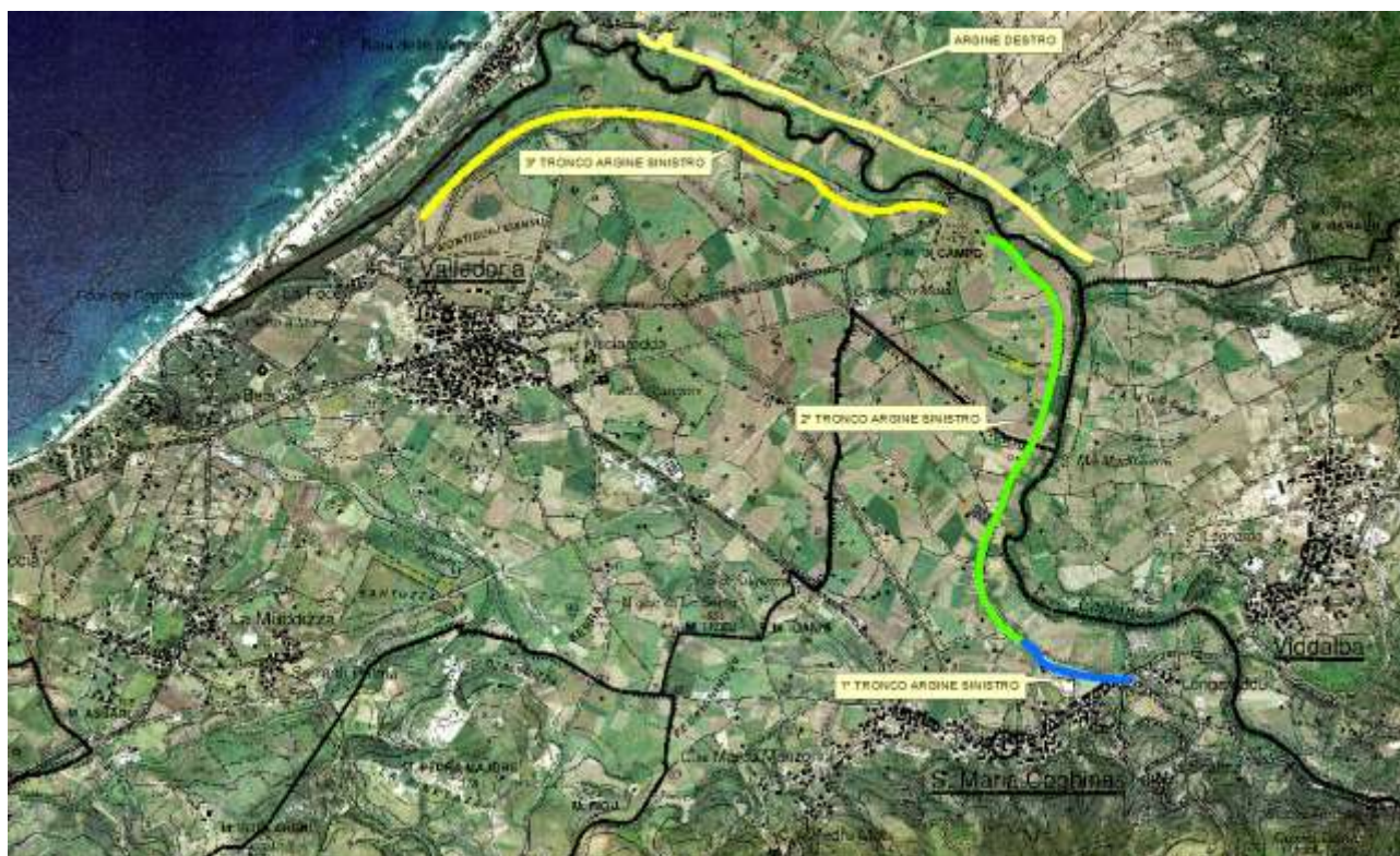
Figura 111.1 - Opere arginali della bassa valle del f. Coghinas: la suddivisione dell'argine in 1° e 2° tronco è ideale, per cui esso in realtà non ha soluzione di continuità.
