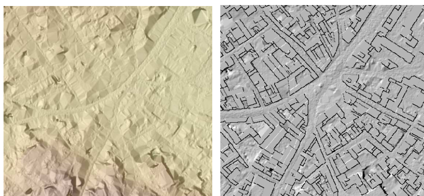
Figura 2–Il modello di terreno (DTM) e il modello di superficie ottenuto integrando il primo con il dataset degli edifici, evidenziati mediante l’ombreggiatura delle forme
